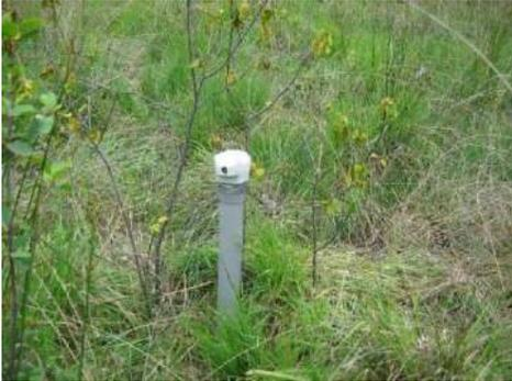
Le fonctionnement du marais sera étudié au travers de l'analyse des variations du niveau d'eau dans le sol relevées par les piézomètres automatiques installés dans le marais
