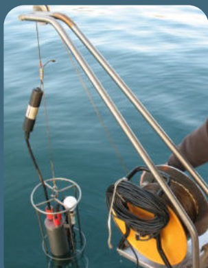
Sonde multiparamètres pour décrypter le lac de la surface au fond (-65m)
