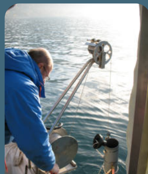
Bouteille à prélèvement intégré pour comprendre les évolutions du lac
