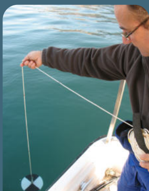
Disque de Secchi pour mesurer la transparence de l'eau
